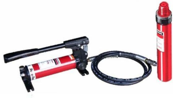
SA-50 油圧ユニット—低価格の経済的な油圧ユニットです。P-75手動ポンプ、Z-864 6 フィートバンタムホース、及びRC-540ラムとから構成されています。このユニットは小型ですが4トンの能力を持ち、他のバンタムラムとも組合せることが出来、お望みの個所に使用することの出来る基本的な油圧ユニットです。
